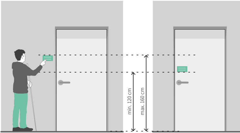
Zasada rozmieszczenia informacji w alfabecie Braille'a.
