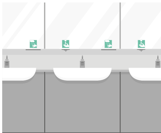
Czytelne oznaczenie funkcji i lokalizacji urządzeń, w przypadku ukrycia ich za lustrem, w ścianie itp.
